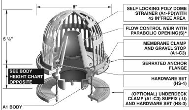
\*5 GPM flow per inch, per slot. \* NOTE: SPECIFY -F1, -F2, -F3 FOR
